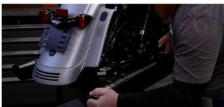
10. スリップオンマフラーを取り外したら、そのままクランプを取り外します。 交換するマフラーに流用するのでクランプ自体をしっかり点検しましょう。
