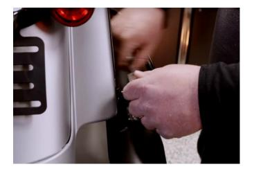
7. 次にクランプのナット緩めます。 クランプやナットの位置にもよりますが、ロングソケット を使用して作業することをお勧めします。 工具をぶつけてキズを付けないように、マフラーやエキ パイと工具のクリアランスを確保し十分に注意しながら
