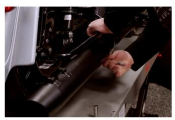
ボルトを外し、クランプをしっかりと緩めたら、 スリップオンマフラーの取り外しです。
