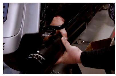
13. 差し込んでゆく際には、ボルトで固定するステーの部分に対してまっすぐ差し込みましょう。 右図のように、ステーとスリップオンマフラーのボルト穴の通りを確認しながら、前後位置しっかりと合わせます。
